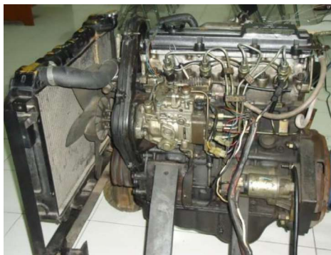
Gambar 2.2 Mesin KIA Diesel yang digunakan pada pengujian
